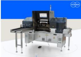
Lösung typischer Probleme mit der halbautomatischen Inspektionsmaschine V90+, insbesondere in Bezug auf folgende Themen:
