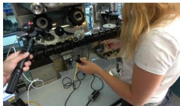
Kalibrierung einer Prüfmaschine mit HVLD:
